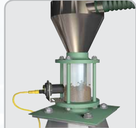
Detección a nivel de bolitas - Un 875CP detecta el nivel de bolitas de plástico a través de una cámara de vidrio
